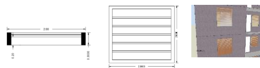
ب: نمای مدل پایه تحقیق در حالت سایه اندازی با کرکره های افقی
