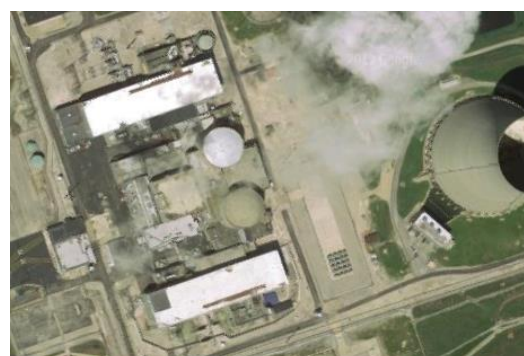
تصویر ۶: سایت پلان طرح نیروگاه هسته‌ای پری در آمریکا؛ (۱) ساختمان راکتور، (۲) ساختمان توربین، (۳) برج خنک‌کننده؛ مأخذ: (www.google.com/maps).
