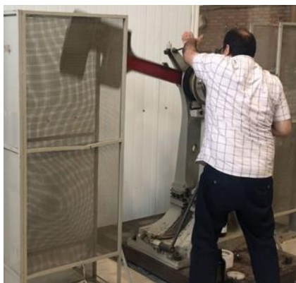
شکل ۸. انجام آزمایش و شکست نمونه‌های ۲۰- درجه در آزمون ضربه شاری
