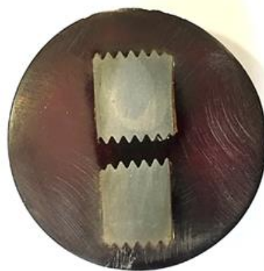
شکل ۴. نمونه‌سازی آزمایش دکربورگی
