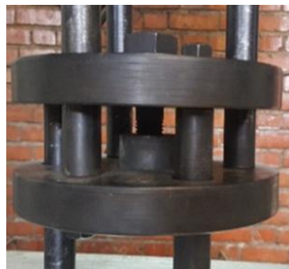
شکل ۱۱. انجام آزمایش کشش پیچ به روش ایزو
