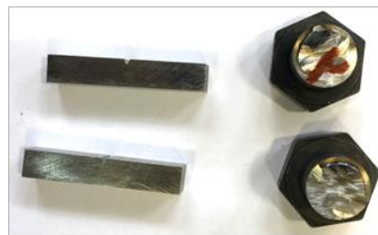
شکل ۶. نمونه‌های ساخته شده برای آزمون ضربه شاری
