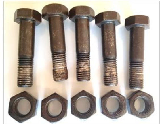
شکل ۱۵. حالات خرابی پنج نمونه پیچ نمره ۲۰ در آزمایش استحکام کششی با مهره
