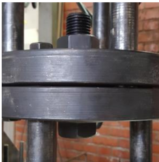
شکل ۱۴. انجام آزمایش کشش با پیچ با مهره
