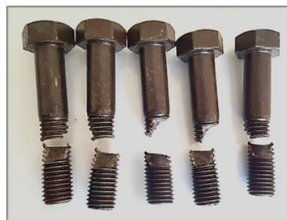
شکل ۱۲. حالات خرابی پیچ نمونه پیچ نمره ۲۰ در آزمایش استحکام کششی با ابزار ایزو
